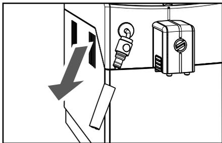
**2** Снимите верхнюю часть насадки Pannarello с трубки пара / горячей воды.
